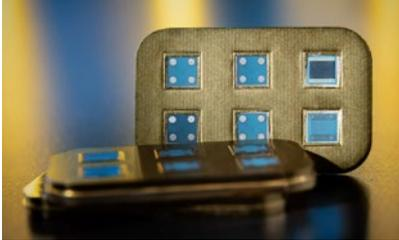
Vollständig hermetisch verkapseltes Modul mit eingetragenen Hochtemperaturkondensatoren, ASIC und Kondensatoren im neuartigen Gehäuseformat
